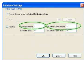
Rysunek 4. Parametry wpisywane dla mikrokontrolera dołączonego do „Slave 1”
