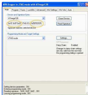
Rysunek 5. Wynik odczytu sygnatury ze złącza „Slave 1”
