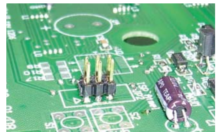
Fotografia 3. Sposób montażu złącza programatora: a) wciśnięcie w płytkę, b) przyłutowanie, c) dosunięcie osłony.
