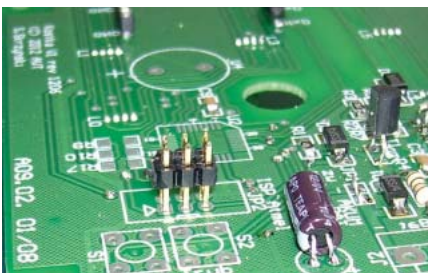
Fotografia 3. Sposób montażu złącza programatora: a) wciśnięcie w płytkę, b) przyłutowanie, c) dosunięcie osłony.
