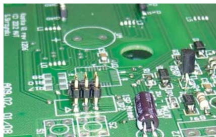
Fotografia 3. Sposób montażu złącza programatora: a) wciśnięcie w płytkę, b) przyłutowanie, c) dosunięcie osłony.
